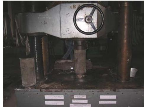
**Gambar 5.** Perawatan benda uji silinder dan pengujian kuat tekan
