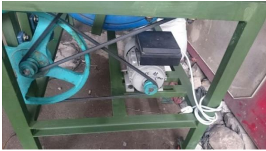
Gambar 12. Motor Listrik, Pulley Dan Sabuk yang Terpasang pada Komposter
