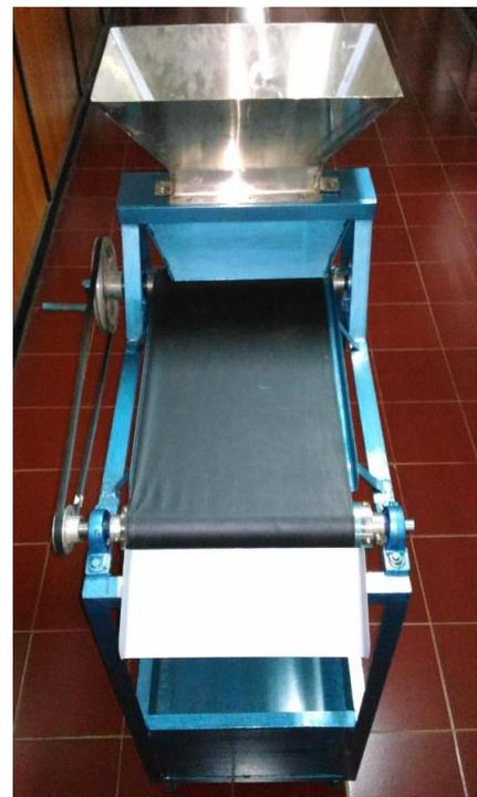
**Gambar 2. Contoh Mesin Pemisah Pasir Besi**
