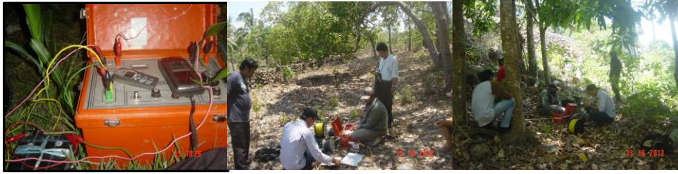
Gambar 2. Foto Geolistrik dan Kegiatan Pengukuran Geolistrik GL-1 & GL-2
