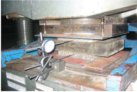
**Gambar 6.** Pengujian kuat geser pelat berbentuk Bujur Sangkar
