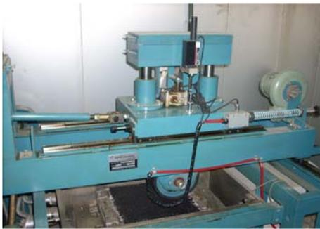
**Gambar 5.** Pemadatan dengan alat Wheel Tracking Machine
