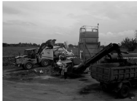
**Gambar 6a.** Unit pencampur campuran dingin dengan *foam bitumen* (KMA 200)
