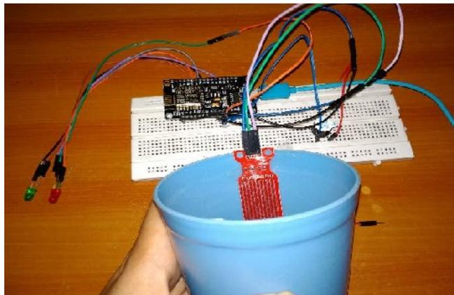
Gambar 9. Proses percobaan pengujian deteksi level air
