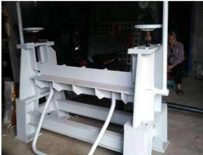
Gambar 7. Mesin Penekuk Plat
