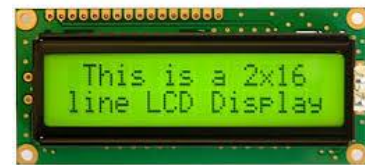
Gambar 6. Modul LCD Karakter 2x16
