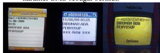
Gambar 14. Karakter SMS Pada Saat Motion Sensor Terdeteksi Oleh Gerakan Orang
