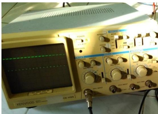
Gambar 12. Gelombang ultrasonik dengan IC NE555 pada osiloskop
