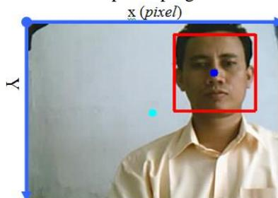
Gambar 7. Hasil deteksi objek di titik (256, 68) *pixel* Berdasarkan hasil pengujian besar *overshoot* pada response tersebut adalah 0% dengan kesalahan hingga mencapai target adalah 2 *pixel* pada arah sumbu x dan 0 *pixel* pada arah sumbu y
