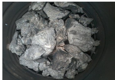
Gambar 2 Pengeringan Lumpur Lapindo Dengan Proses Pembakaran
