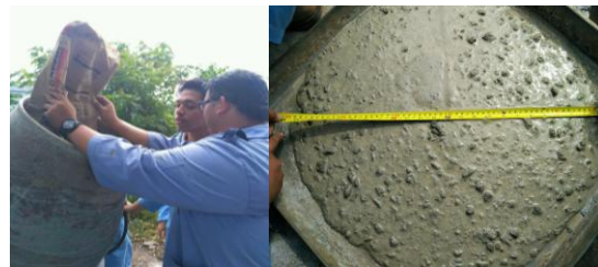
Gambar 1 : Memasukkan Mix Design Gambar 2 : Mengukur Hasil Uji Slump
