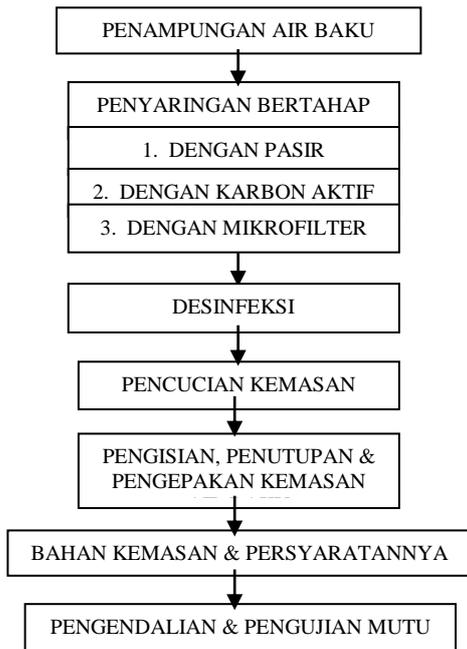
Gambar 1. Diagram Alir Proses Produksi Air Minum Dalam Kemasan (AMDK)
