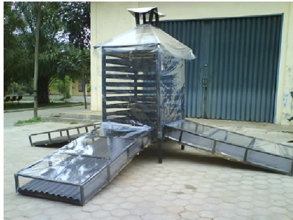
Gambar 2. Alat pengering energi surya dengan kolektor keping datar
