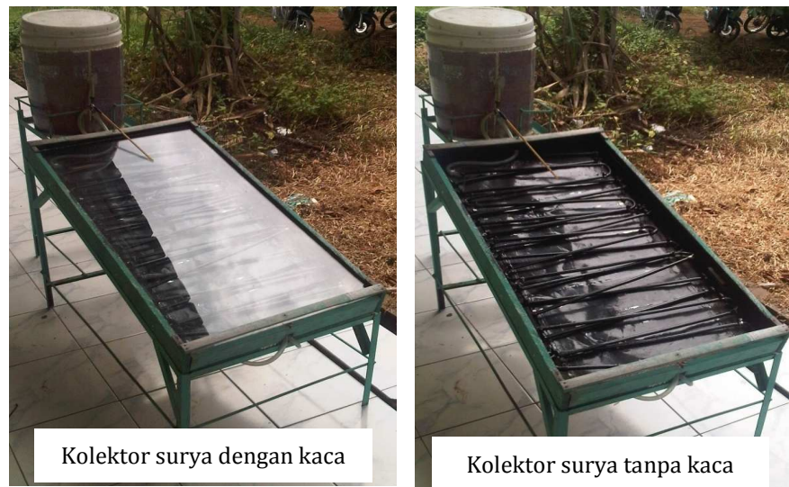
Gambar 2. Hasil rancangan alat pengumpul panas energi matahari dengan sistem termosifon
