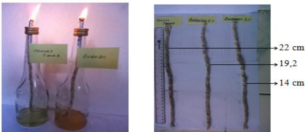
Gambar 5. Uji nyala dan kapilaritas biodiesel dengan lampu minyak tanah
