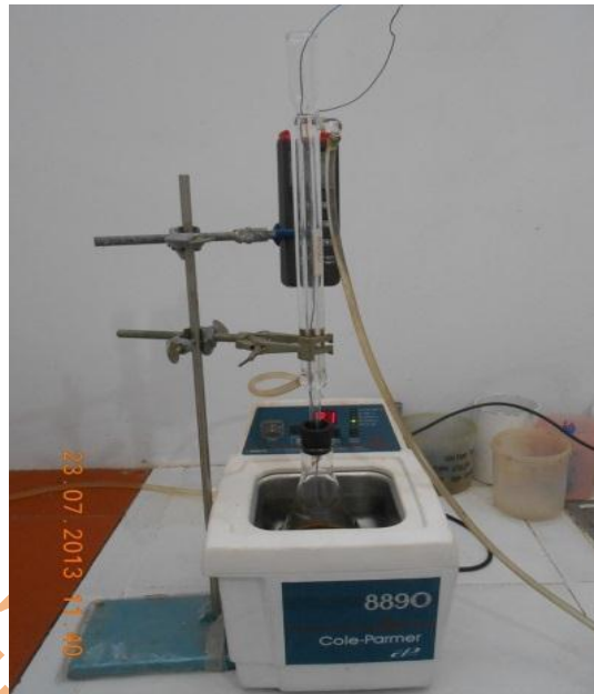
Gambar 1. Rangkaian alat pada produksi biodiesel
