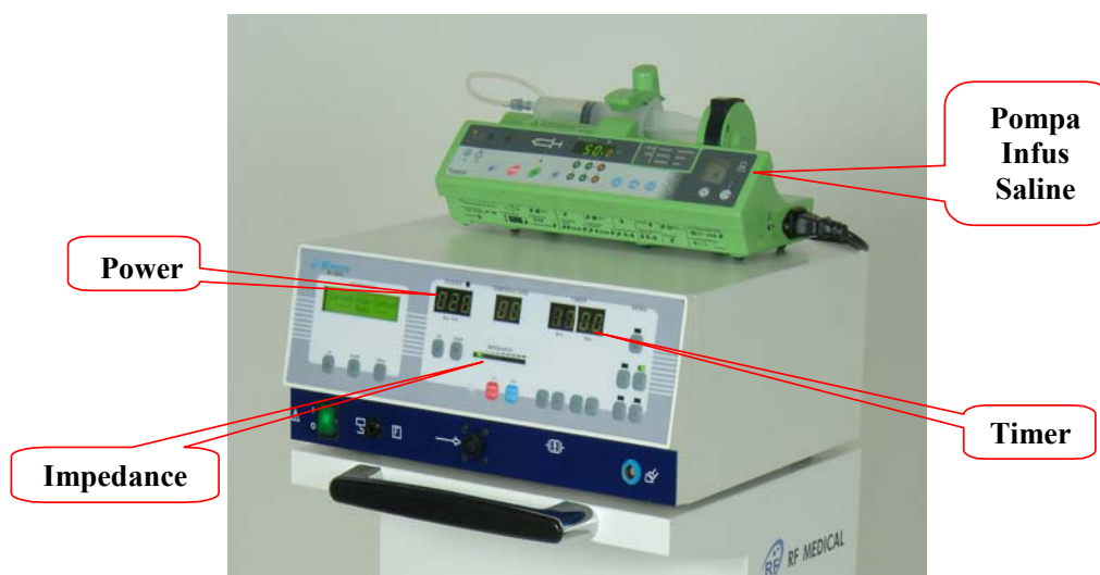
Gambar 1. RF generator dengan pompa infus (Sumber: Jeong Jae Lee, M.D., Ph.D., dari Department of Obstetrics and Gynecology, Soonchunhyang University Hospital, Seoul, Korea)
