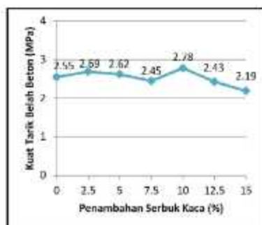
Gambar 6. Hubungan antara besar penambahan serbuk kaca pada beton dengan kuat tarik belah beton
