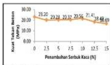
Gambar 5. Hubungan antara besar penambahan serbuk kaca pada beton dengan kuat tekan beton
