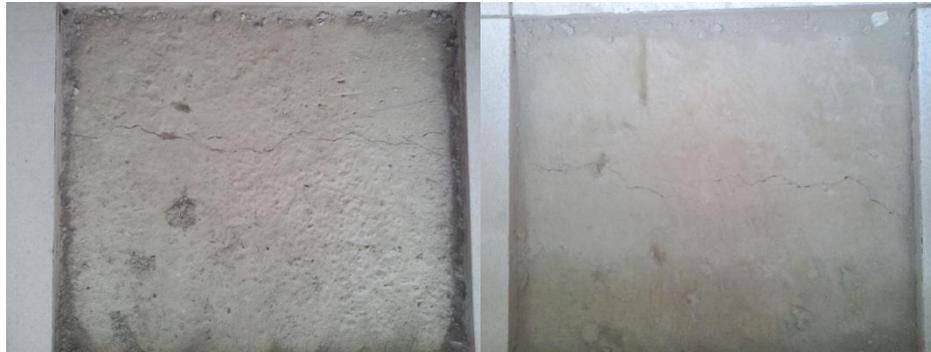
Gambar 3. Retakan pada Pelat yang Melendut
