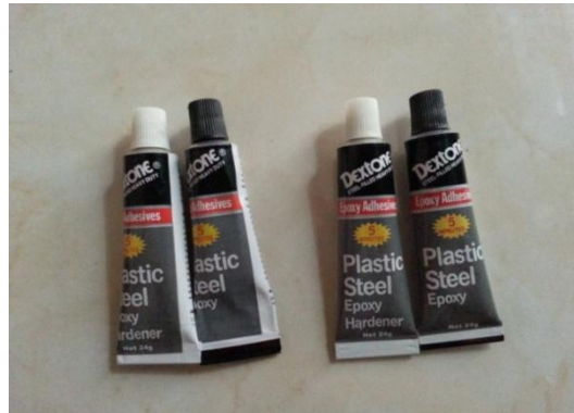
Gambar 1. Contoh pengisian tube yang gagal (kiri) dan yang berhasil (kanan)
