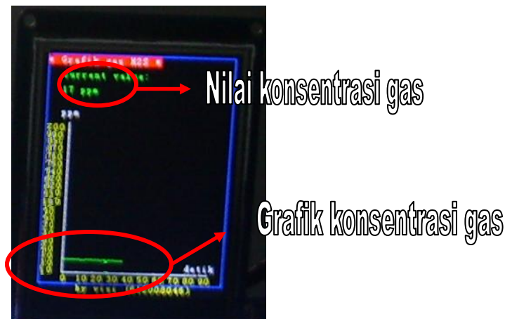
Gambar 12. Pengujian grafik gas H_2S terhadap waktu pada layar LCD grafik
