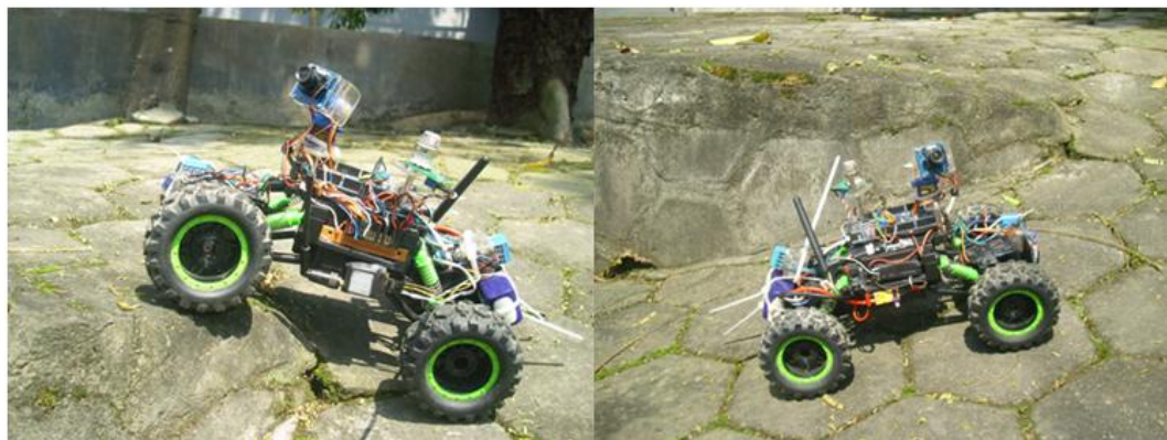
Gambar 10. Pengujian robot terhadap keterjalan dan kemiringan medan lapangan
