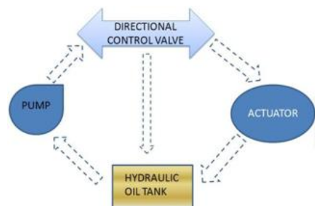
Gambar 3. Mekanisme kerja hidrolik
