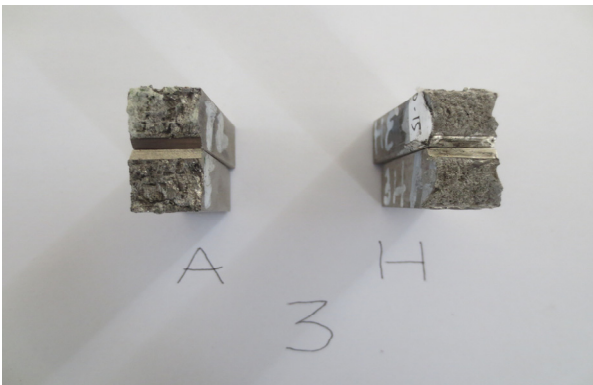
Gambar 23. Patahan serabut pada produk cor 3, A: sebelum perlakuan panas, H: setelah perlakuan panas
