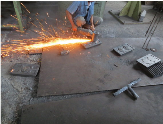
Gambar 4. Proses pemotongan sistem saluran tuang produk cor jaw plate
