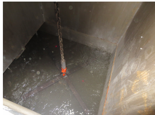
Gambar 6. Proses pencelupan produk cor jaw plate ke dalam bak yang berisi air
