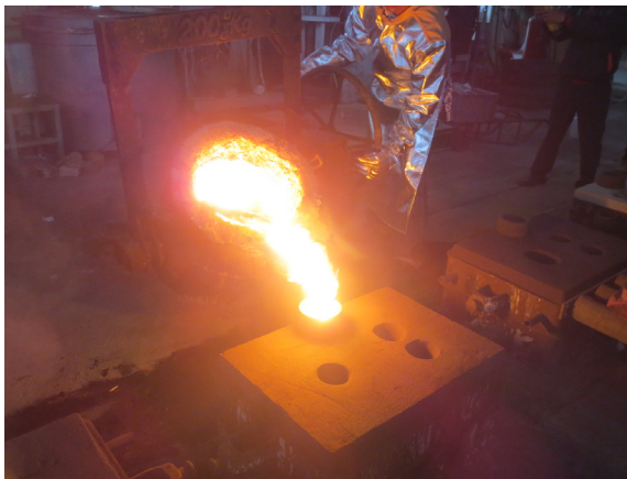
Gambar 3. Proses penuangan cairan logam ke dalam cetakan pasir jaw plate
