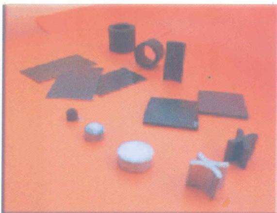
**Gambar 4.** Beberapa hasil fabrikasi skala laboratorium bahan *Bonded Magnet* berbasis Pasir Besi
