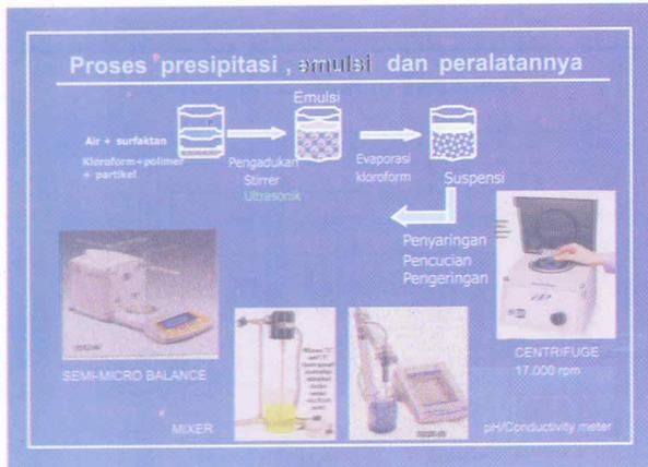
**Gambar 8.** Proses Presipitasi, emulsi serta peralatannya untuk membuat nanopartikel magnet di PTBIN - BATAN
