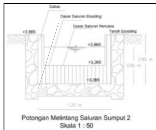
Gambar 5. Rehabilitasi Saluran Sump 2
