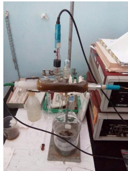
Gambar 3. Alat uji korosi sel tiga elektroda di PSTA Batan Yogyakarta.
