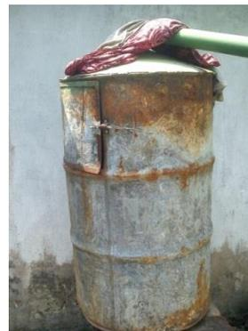
**Gambar 3.** Drum untuk Proses Karbonasi
