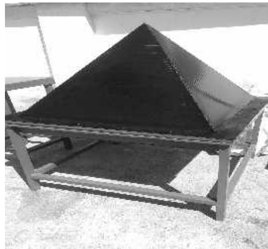
Gambar 2. Miniatur atap desalinasi evaporasi
