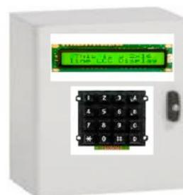
Gambar 3. Keypad untuk melakukan seting temperatur dan kelembaban ruang kumbung jamur merang
