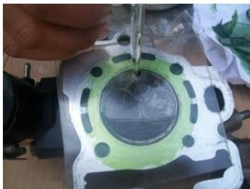
Gambar 9. Pengujian volume kubah kepala silinder
