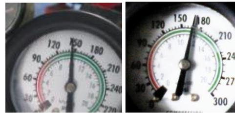
Gambar 10. (a) Tekanan silinder standar. (b) Tekanan silinder setelah modifikasi
