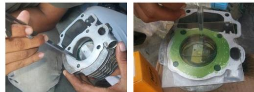
Gambar 8. (a) Memasang piston pada posisi 20 mm dari TMA (b) Pengujian volume kepala piston
