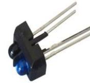
Gambar 2 Sensor Infra Merah ( http://www.iseerobot.com )
