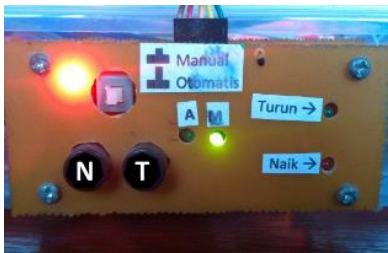
Gambar 16. Uji panel antarmuka mode kontrol pintu air
