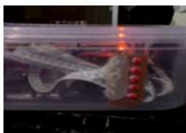
Gambar 25. LED Indikator tidak menyala menunjukkan sisa pakan 5%
