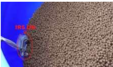
Gambar 11. Sensor IR5 dalam kondisi ON menunjukkan sisa pakan 80%
