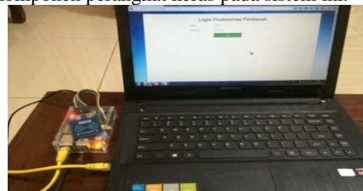
Gambar 9 Perangkat RFID reader terkomunikasi dengan Raspberry Pi
