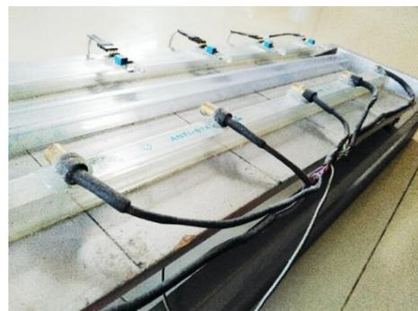
**Gambar 12.** Tata Letak Dioda Laser
