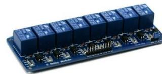
Gambar 4. Relay module
