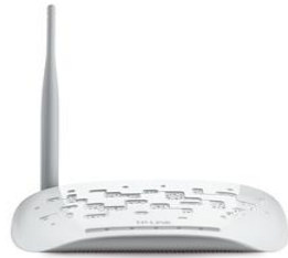
Gambar 6. Bentuk Fisik Access Point TL-WA701ND
