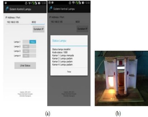
Gambar 10. Hasil pengujian perintah "Lampu 1 ON" (a) Tampilan pada aplikasi Android (b) Tampilan pada lampu
