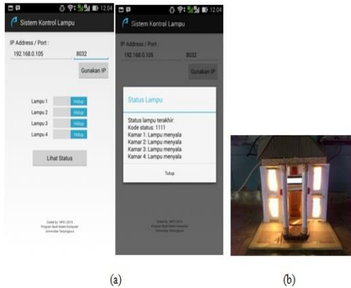
Gambar 13. Hasil pengujian perintah “Lampu 4 ON” (a) Tampilan pada aplikasi Android (b) Tampilan pada lampu
