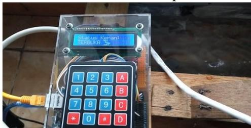
Gambar 18: Status Keran atau *Solenoid Valve*
