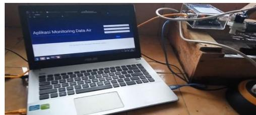
Gambar 19: Menghubungkan Arduino pada PC Menggunakan LAN.
