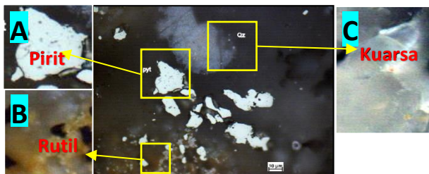
Gambar. 2 Tampak sebaran pirit (warna terang), rutil (kuning kecoklatan), dan kuarsa (putih transparan) pada spent ore 1 (zoom 50x).
