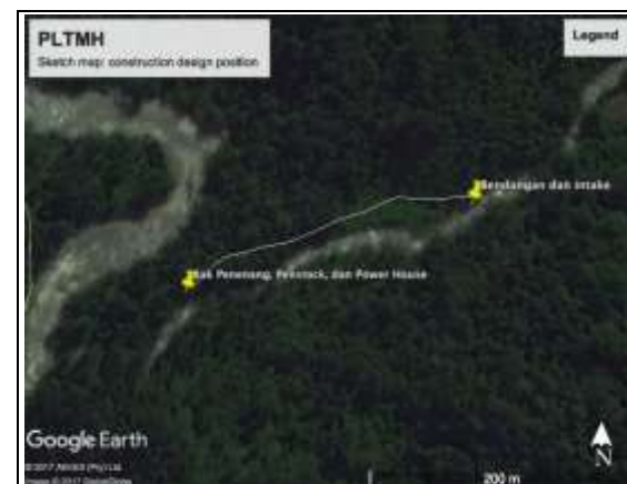
Gbr 6. Posisi konstruksi PLTMH yang menggambarkan jarak saluran pembawa 285 m.
