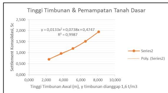
**Gambar 6.** Hubungan *Settlement* Konsolidasi dengan Tinggi Timbunan
