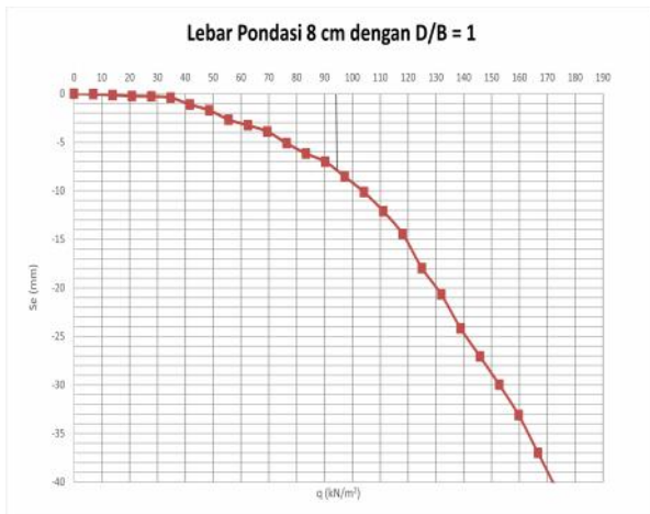
Gambar 11. Hubungan q dan Penurunan Pondasi Tanpa Perkuatan Lebar 8 cm dengan D/B = 1
