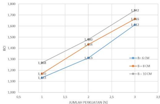
Gambar 10 Hubungan nilai *Bearing Capacity Improvement* (BCI) dan jumlah lapis perkuatan geogrid (N) pada tanah pasir dengan variasi lebar pondasi (cm)
