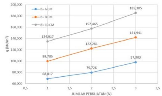
Gambar 6 Hubungan tegangan tanah (kN/m<sup>2</sup>) dan jumlah perkuatan geogrid (N) dengan variasi lebar pondasi
