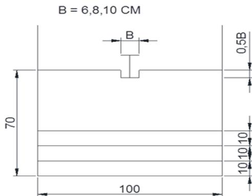
Gambar 2 Bentuk perlakuan benda uji tanpa menggunakan perkuatan
