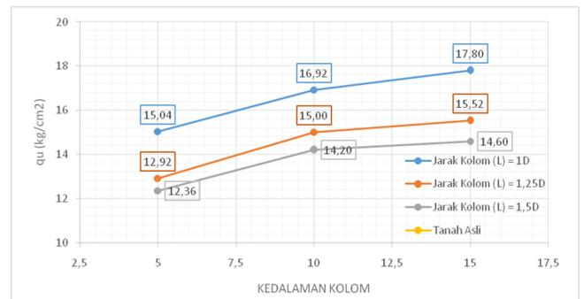
**Gambar 10.** Perbandingan nilai daya dukung dengan variasi kedalaman kolom ( $D_f$ ) terhadap jarak antar kolom ( $L$ )
