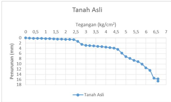
**Gambar 8.** Hubungan tegangan dengan penurunan tanah asli
