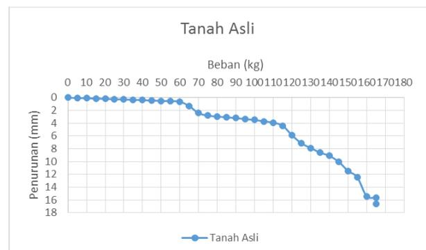
**Gambar 7.** Hubungan beban dengan penurunan tanah asli
