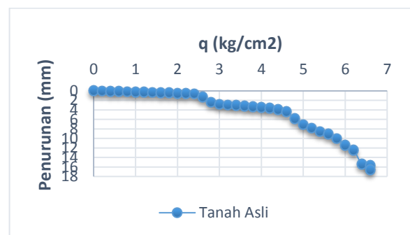
Gambar 4 Hubungan daya dukung dengan penurunan tanah asli
