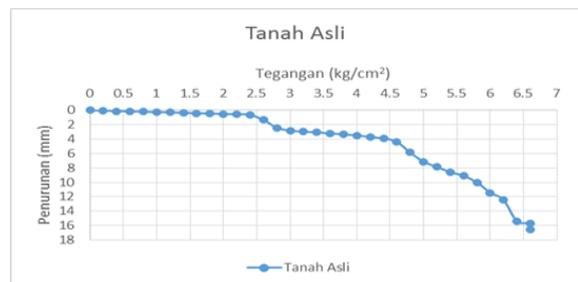
**Gambar 6** Hubungan tegangan dengan penurunan tanah asli
