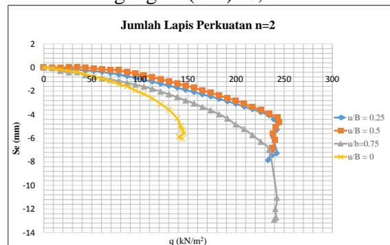
**Gambar 5 .** Grafik hubungan  $q_u$  dan penurunan pada model tanah pasir dengan perkuatan geogrid dan tanpa perkuatan dengan rasio jarak lapis pertama perkuatan geogrid ( $u/B$ )=0,5
