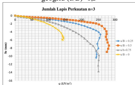
**Gambar 6 .** Grafik hubungan  $q_u$  dan penurunan pada model tanah pasir dengan
