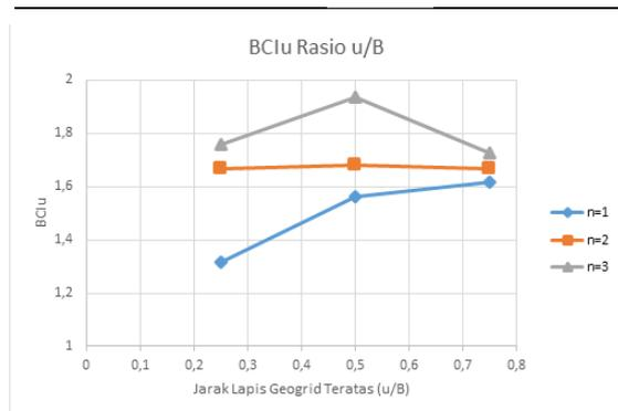
**Gambar 10 .** Perbandingan nilai BCIu untuk variasi rasio u/B
