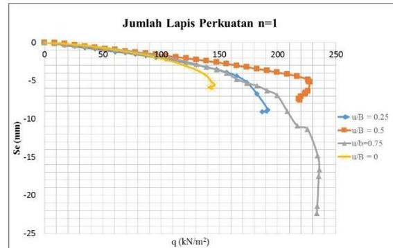
**Gambar 4 .** Grafik hubungan  $q_u$  dan penurunan pada model tanah pasir dengan perkuatan geogrid dan tanpa perkuatan dengan rasio jarak lapis pertama perkuatan geogrid ( $u/B$ )=0,25
