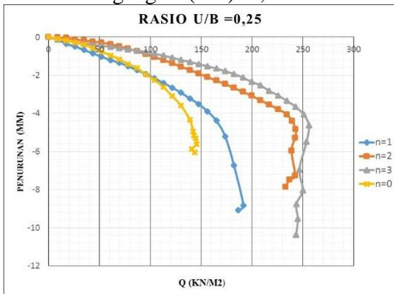
**Gambar 7 .** Grafik hubungan qu dan penurunan pada model tanah pasir dengan perkuatan geogrid dan tanpa perkuatan dengan rasio jarak lapis pertama perkuatan geogrid (u/B)=0,25
