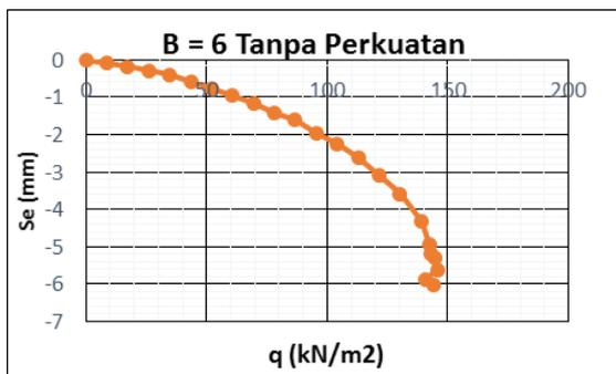
**Gambar 3 .** Grafik hubungan  $q_u$  dan penurunan pada model tanah pasir tanpa perkuatan
