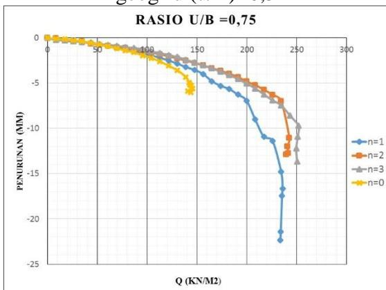
**Gambar 9 .** Grafik hubungan qu dan penurunan pada model tanah pasir dengan perkuatan geogrid dan tanpa perkuatan
