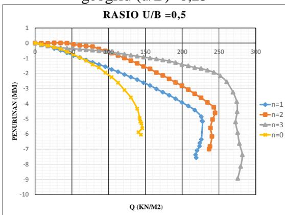
**Gambar 8 .** Grafik hubungan qu dan penurunan pada model tanah pasir dengan perkuatan geogrid dan tanpa perkuatan dengan rasio jarak lapis pertama perkuatan geogrid (u/B)=0,5
