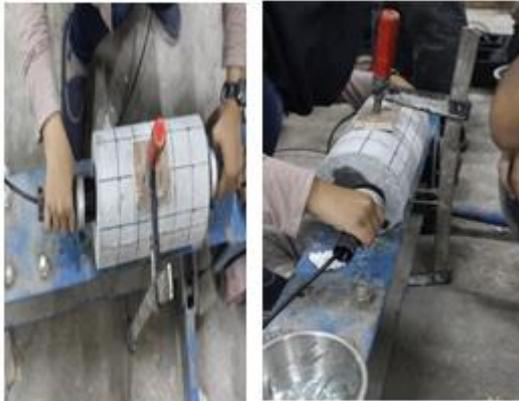
**Gambar 5.** Pengujian menggunakan uji UPV test
