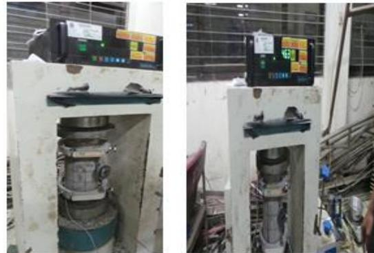
**Gambar 3.** Pengujian menggunakan uji kuat tekan beton (*compression test*)
